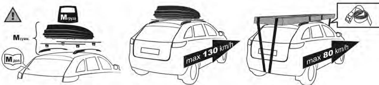
Скорость движения с габаритным и тяжелым грузом не должна превышать 80км/ч, и ни при каких прочих условиях скорость автомобиля с грузом не должна превышать 130км/ч.
